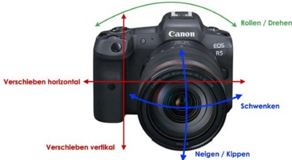
Das RF 100mm F2.8 L Macro USM verfügt über einen 5-Stufen-IS und schafft mit der internen Stabilisierung der Kameras bis zu 8 Stufen, beim RF 35mm F1.8 Macro IS STM sind es zusammen 7 Stufen.
