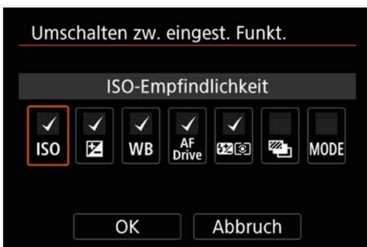
Durch Drücken der INFO.Taste bei [Umschalten zwischen eingestellten Funktionen] werden die Optionen zur Detailsinstellung angezeigt. Hier kann man dann die Funktionen, zwischen denen eine Umschaltung erfolgen soll, auswählen.
