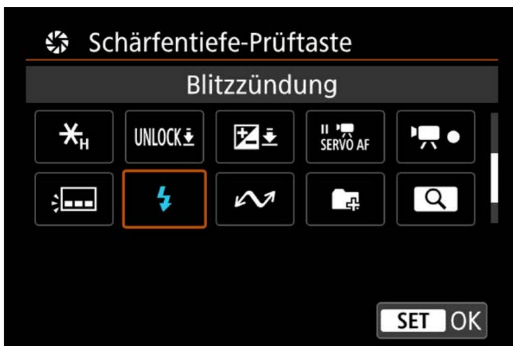
Wenn du [Blitzzündung] einer bestimmten konfigurierbaren Taste zugewiesen hast, wird die Blitzauslösung bei jedem Drücken der Taste aktiviert oder deaktiviert.
