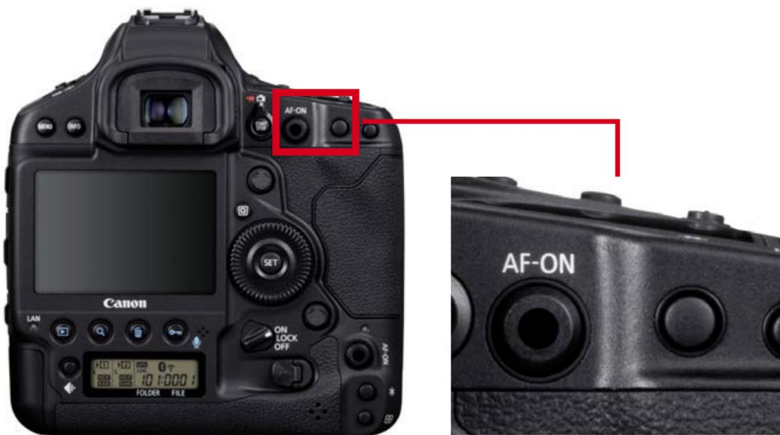
[One-Shot ↔ AI Servo] kann auf fünf Tasten wie AF-ON und \* gelegt werden. Wenn
