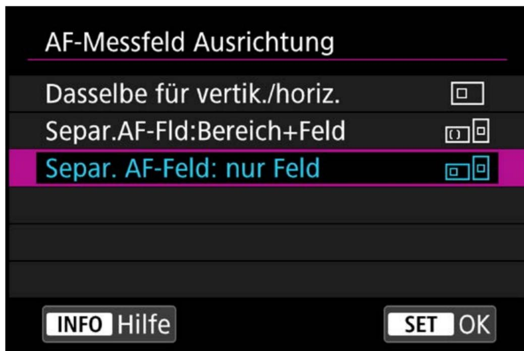
Eine weitere Einstellung unter [AF-Messfeld Ausrichtung] ist [Separate AF-Felder: nur Feld]. Damit lassen sich im selben [Wahlmodus AF-Bereich] unterschiedliche AF-Felder für das Hoch- und Querformat festlegen. Da die Einstellung sehr einfach ist, ist diese Funktion ideal in Aufnahmesituationen, in denen zwischen Hoch- und Querformat gewechselt wird und derselbe [Wahlmodus AF-Bereich] festgelegt wurde.
