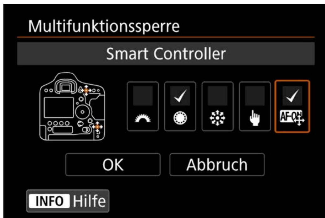
Reiter [📷 6] [Smart Controller] unter [Multifunktionssperre] auswählen und mit [OK] bestätigen.
