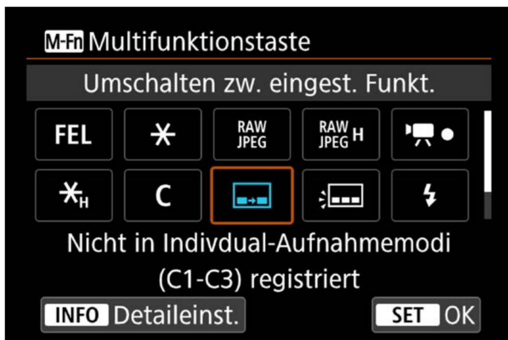
[Umschalten zwischen eingestellten Funktionen] mit [Custom-Steuerung] auf die M-Fn Taste legen. Mit dieser Zuordnung kann man zwischen Aufnahmeeinstellungen wie ISO-Empfindlichkeit, Belichtungs-korrektur oder Weißabgleich umschalten und diese mit dem Wahhrad jeweils anpassen.
