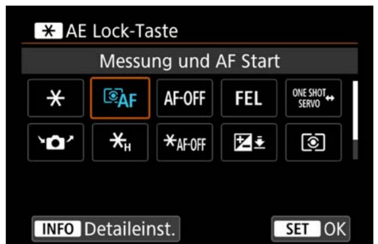
Schalte die AF-ON Taste [AUS], aktiviere die [Direktauswahl AF-Feld] für den <Smart Controller> und lege [Messung und AF Start] auf die \* Taste (alles im Menüpunkt [Custom-Steuerung]).
