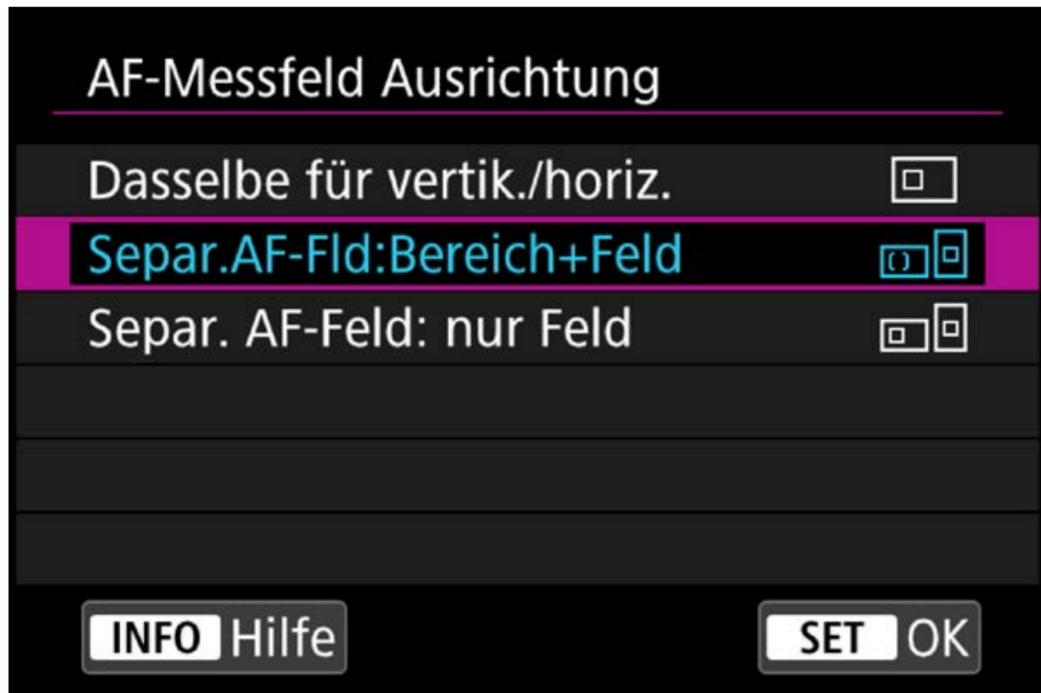
Zunächst wählst du [Separate AF-Felder: Bereich + Feld] unter [AF-Messfeld Ausrichtung]. Nun wird der [Wahlmodus AF-Bereich] und die AF-Felder für die Kameraausrichtung festgelegt (A: Querformat, B: Hochformat mit Griff oben und C: Hochformat mit Griff unten).
