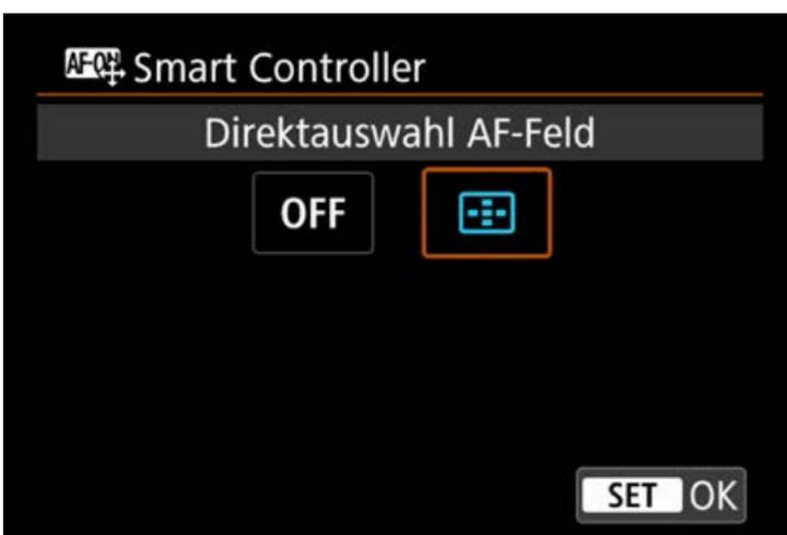
In der [Custom-Steuerung] stellst du unter [Smart Controller] [Direktauswahl AF-Feld] ein.
