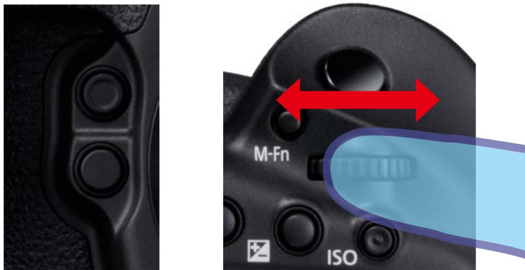
Die ausgewählte Taste drücken und gleichzeitig am Hauptwahlrad drehen
